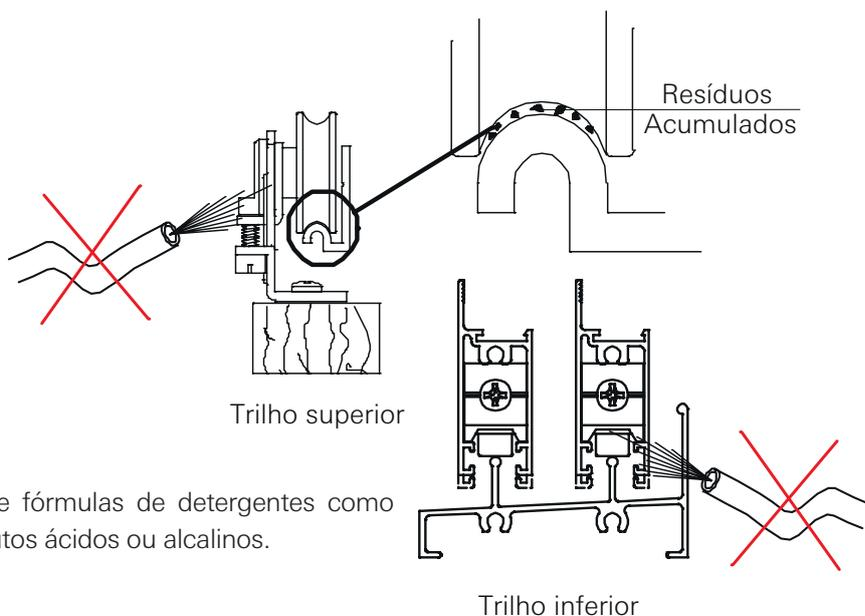
**ATENÇÃO:** Ao lavar as janelas não jogue o jato d'água diretamente nas roldanas, independente se usa mangueira de jardim ou máquinas de alta pressão tipo "VAP".
